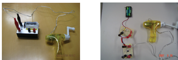
図1「手力ためる君」(左図)とその基板キット(右図)の概観図。右図においては「整流部」、「電流方向指示部」、「充電部」の3つのパーツで構成されている。
