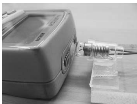
図4：(左)実験の概略図。(右)豆電球と照度計の拡大図。豆電球と照度計は、計測部分と豆電球を接触させた。電圧計・電流計は、METEX社製デジタルマルチメータM-4660Aを、照度計は、MASTECH社製デジタルマルチメータMS-8209を使用した(照度計・電流計・電圧計は、以下の実験でも同様)。
