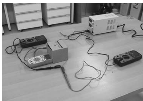
図4：(左)実験の概略図。(右)豆電球と照度計の拡大図。豆電球と照度計は、計測部分と豆電球を接触させた。電圧計・電流計は、METEX社製デジタルマルチメータM-4660Aを、照度計は、MASTECH社製デジタルマルチメータMS-8209を使用した(照度計・電流計・電圧計は、以下の実験でも同様)。
