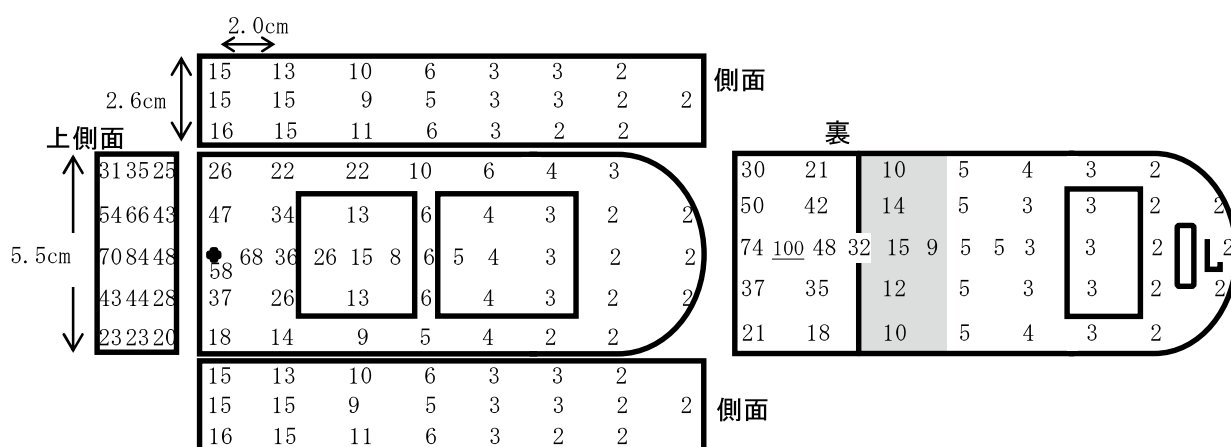
図5 「はかるくんⅡ」表面の放射線量の分布。最大値 4.632\mu\text{Sv/h} を100として百分率で表記している。
