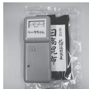
図8 左：カリウム40の崩壊図 7) 。右：ベータちゃんを使った測定の様子。
