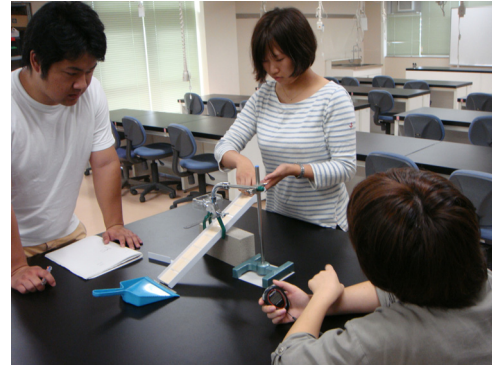
図 2. 洗濯板モデルの外観(a)と実践の様子(b)。パチンコ玉を落とす人、時間をはかる人、騒音計を観測する人の最低 3 名以上の人員を要する。
